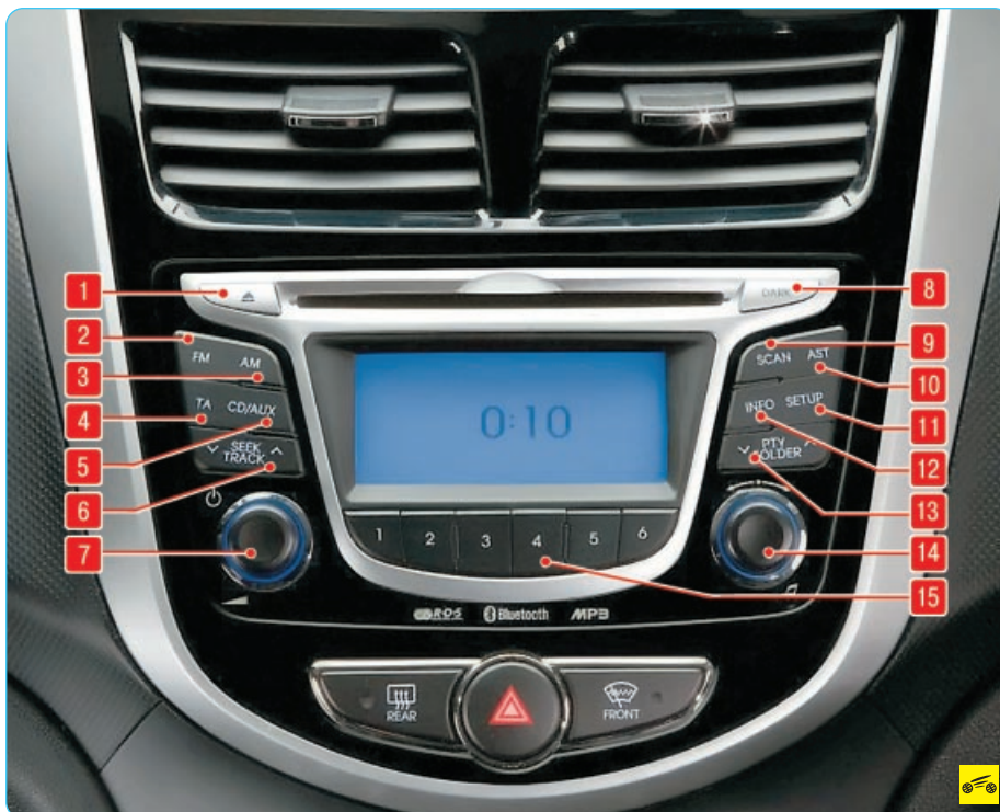
Рис. 1.13. Органы управления аудиосистемой: 1 – клавиша выталкивания диска; 2 – клавиша выбора диапазона ультратракоротких волн (FM); 3 – клавиша выбора диапазона средних волн (AM); 4 – клавиша выключения объявлений о ситуации на дороге (TA); 5 – выбор режима воспроизведения диска (CD/AUX); 6 – клавиши поиска радиостанций (в режиме радио), переключения треков (в режиме CD); 7 – выключатель и регулятор громкости; 8 – клавиша управления подсветкой дисплея аудиосистемы; 9 – сканирование радиочастот (SCAN); 10 – клавиша автоматического выбора и сохранения каналов с высоким уровнем приема для многофункциональных клавиш (AST); 11 – клавиша вызова настроек аудиосистемы (SETUP); 12 – вызов информационной строки (INFO); 13 – клавиши для выбора активной папки; 14 – клавиша воспроизведения/рукоятка выбора треков или радиостанций; 15 – многофункциональные клавиши
