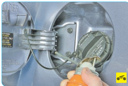
9. Петля и фиксатор крышки люка наливной горловины топливного бака (силиконовая смазка или ВТВ-1 в аэрозольной упаковке).
