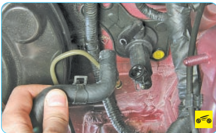
12. Отсоедините шланг от штуцера главного цилиндра привода выключения сцепления и снимите его.
