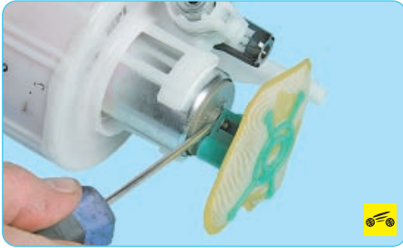
18. Подденьте отверткой фильтр грубой очистки топлива...
