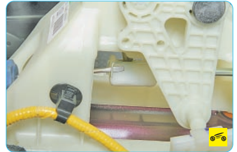
18. Отожмите отверткой концы пружинного фиксатора.
