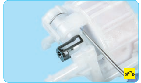
28. Разожмите ушки фиксатора регулятора давления топлива...
