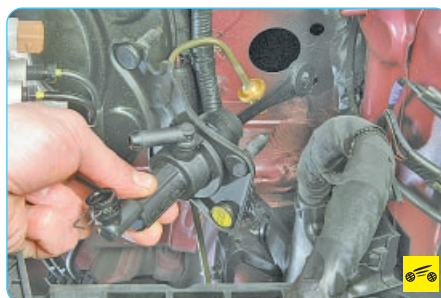
19. Извлеките главный цилиндр привода выключения сцепления из моторного отсека.
