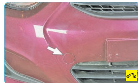
Отверстие для установки съемной проушины для буксировки находится в правой части переднего бампера.
