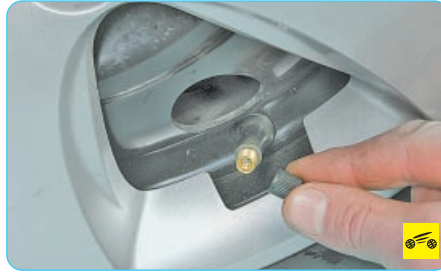
1. Отверните колпачок от вентиля.
