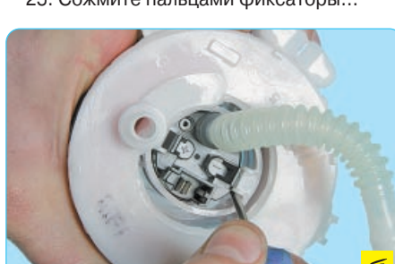
25. Сожмите пальцами фиксаторы...
