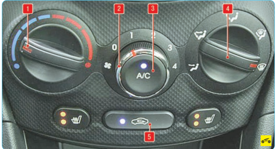
Рис. 1.11. Блок управления системой отопления (кондиционирования) и вентиляции с ручным режимом управления: 1 – регулятор температуры поступающего в салон воздуха; 2 – переключатель режимов работы электровентилятора; 3 – выключатель системы кондиционирования; 4 – регулятор выбора режима распределения воздушных потоков; 5 – выключатель режима рециркуляции
