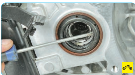
4. Извлеките сальник отверткой.
