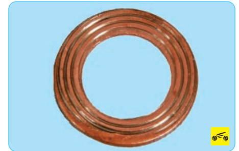
Шайбы при сборке замените новыми.
