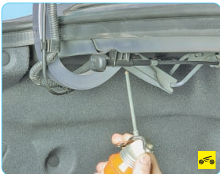
8. Петли крышки багажника (силиконовая смазка или ВТВ-1 в аэрозольной упаковке).
