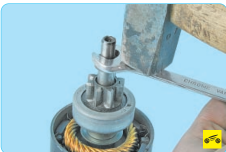
9. Сдвиньте по валу ротора ограничительное кольцо.
