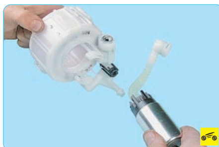
27. ... и извлеките электробензонасос из корпуса топливного модуля.
