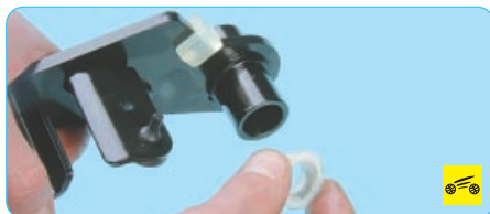
19. Извлеките из отверстий педали пластмассовые втулки.
