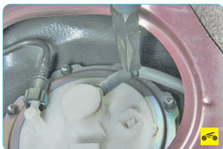
5. Сожмите пассатижами и отведите хомут крепления по шлангу обратного трубопровода.
