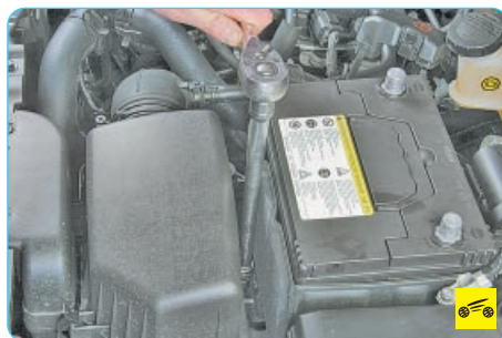
8. Выверните болт крепления прижимной планки...
