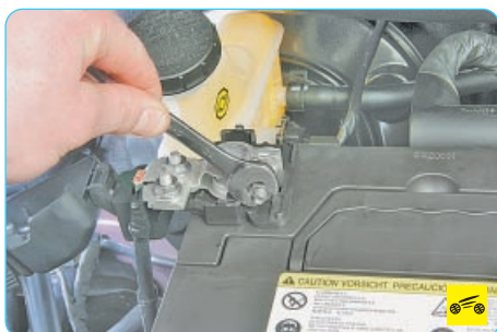
6. Ослабьте затяжку гайки стяжного болта наконечника...
