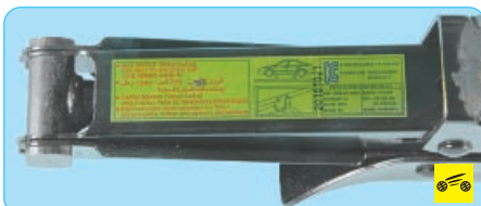
На домкрат наклеена табличка с указанием мест для установки его под автомобиль.
