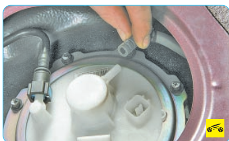
6. Снимите шланг со штуцера топливного модуля.
