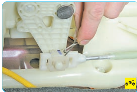
14. ...и извлеките шплинт из отверстия пальца рычага переключения передач с правой стороны.
