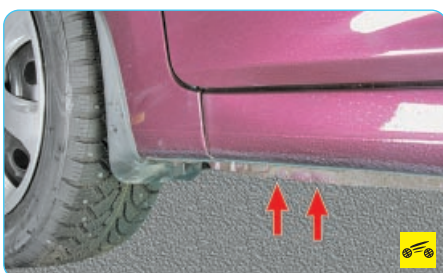
8. Установите домкрат под порог кузова между насечками таким образом, чтобы ребро порога разместилось над пазом лапы домкрата.
