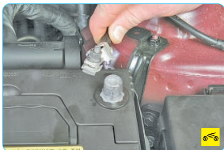
3. ...и отсоедините провод от клеммы «минус» аккумуляторной батареи.
