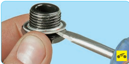
Если шайба сильно обжата, обязательно замените ее.
