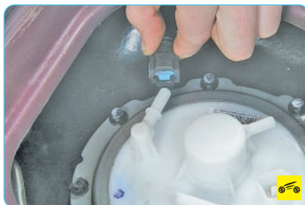
8. ...и снимите топливопровод со штуцера топливного модуля.
