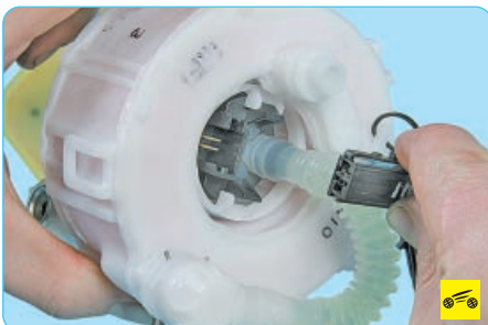
21. Отсоедините колодку жгута проводов от электробензонасоса.
