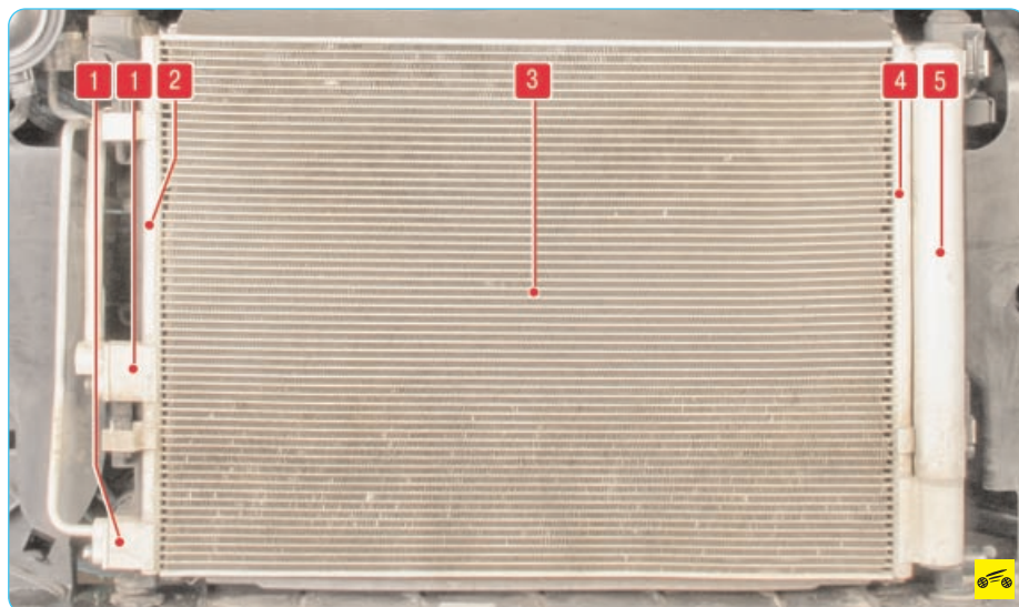
Рис. 12.4. Конденсор: 1 – фланцы крепления трубопроводов; 2, 4 – бачки конденсора; 3 – соты; 5 – ресивер-осушитель
