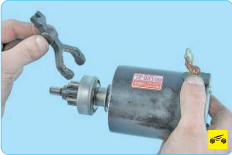
8. Снимите рычаг привода муфты свободного хода.
