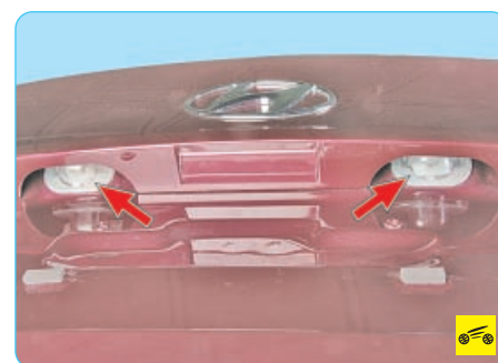
Лампы фонарей освещения номерного знака, тип лампы W5W L/L (5 Вт).
