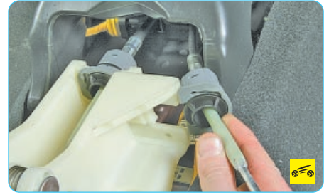
17. ...и извлеките наконечник оболочки троса переключения передач из паза в корпусе кулисы рычага управления.
