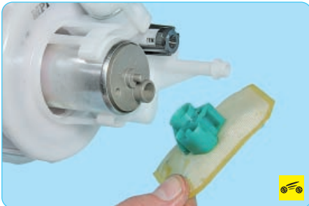
19. ...и отсоедините фильтр от штуцера электробензонасоса.
