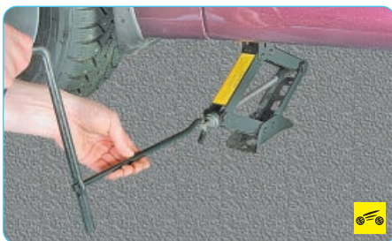
9. Вращая рукоятку по часовой стрелке, раздвиньте домкрат таким образом, чтобы ребро порога вошло в паз лапы домкрата.
