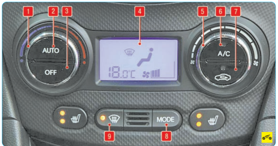
Рис. 1.12. Автоматическая система управления микроклиматом: 1 – регулятор температуры поступающего в салон воздуха; 2 – клавиша включения режима автоматического управления системой отопления (кондиционирования) и вентиляции салона; 3 – клавиша выключения режима автоматического управления системой отопления (кондиционирования) и вентиляции салона; 4 – дисплей; 5 – регулятор скорости вращения электровентилятора; 6 – выключатель режима рециркуляции; 7 – выключатель кондиционера; 8 – клавиша выбора режима распределения воздушных потоков; 9 – выключатель обогрева зоны покоя очистителей ветрового стекла
