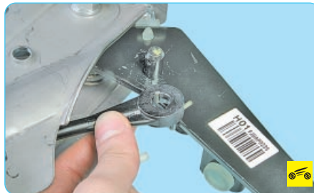
17. ...и снимите с оси педали наконечник штока главного цилиндра привода выключения сцепления.
