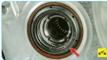
Если шайба сильно обжата, обязательно замените ее.
