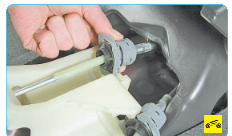
21. ...и извлеките из паза в корпусе кулисы наконечник оболочки троса выбора передач.
