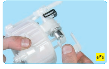
29. ...и снимите фиксатор регулятора давления топлива.
