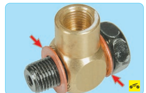
Обратите внимание на наличие и взаимное расположение двух медных уплотнительных шайб.
