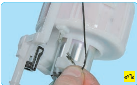
20. Отсоедините наконечник провода от вывода корпуса топливного модуля.
