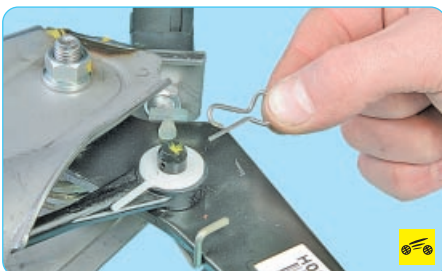
14. ...и извлеките его из отверстия оси крепления наконечника штока главного цилиндра привода выключения сцепления.
