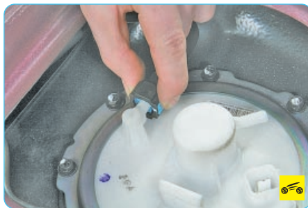
7. Сожмите пластмассовые защелки фиксатора наконечника топливопровода...
