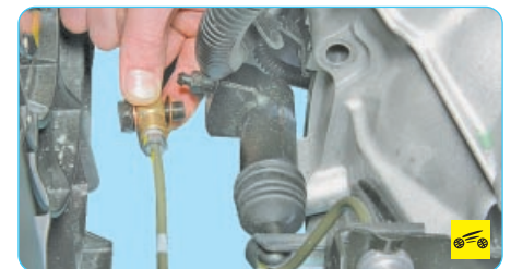
2. ...и отведите его от рабочего цилиндра. Заглушите отверстие штуцера, чтобы не вытекала тормозная жидкость.
