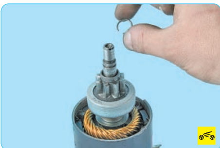
11. ...и снимите кольцо с вала ротора.
