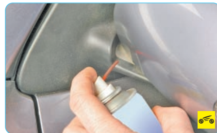
10. Шарниры наружных зеркал (силиконовая смазка или ВТВ-1 в аэрозольной упаковке).
