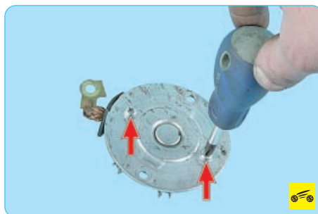
16. Выверните два винта...
