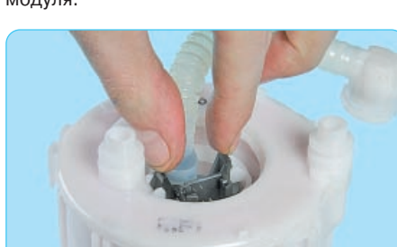
24. Отсоедините наконечник топливной магистрали от штуцера корпуса топливного модуля.
