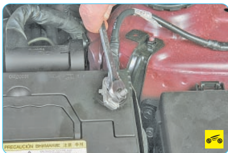
2. Ослабьте затяжку гайки стяжного болта наконечника...
