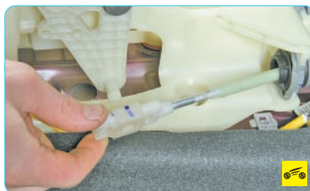
15. Снимите с пальца рычага наконечник троса переключения передач.
